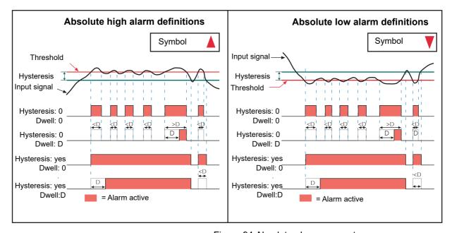
Figure 94 Absolute alarm parameters
